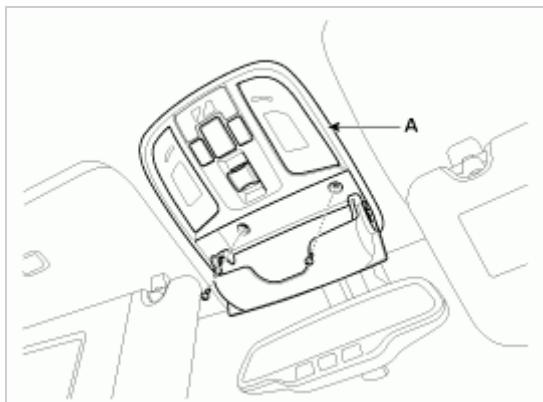
3. 检查端子间的导通性，如果导通性不在规定值范围内，更换天窗开关。
